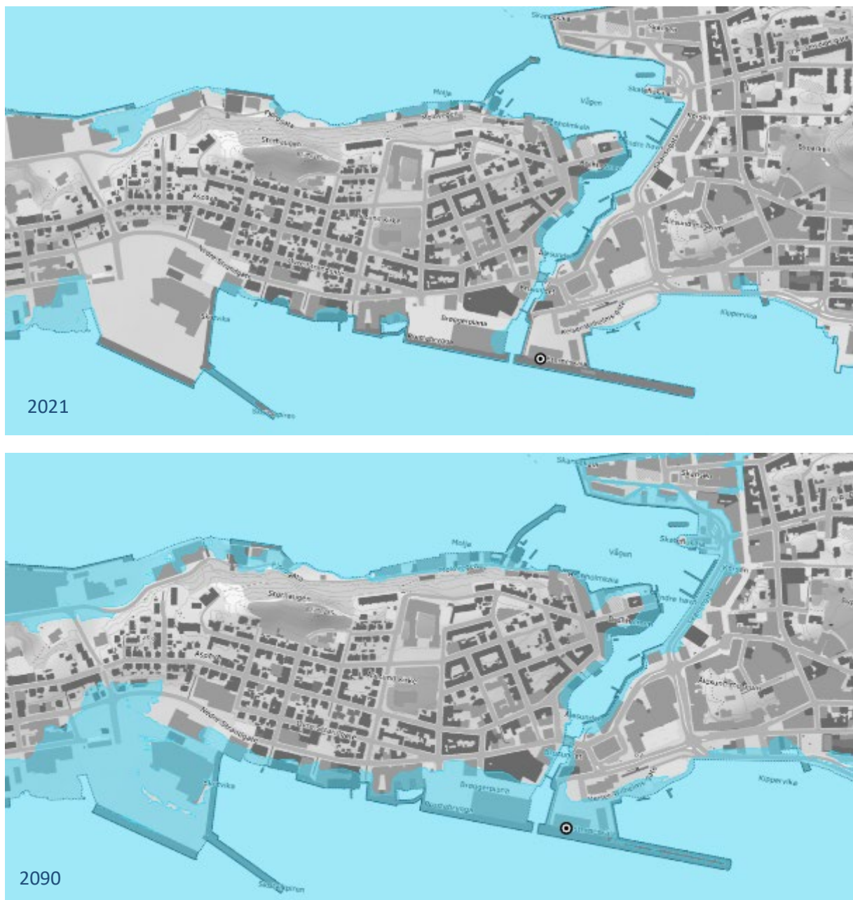
Figur 6. Overfløymde areal i Ålesund sentrum ved 200-års stormflo i dag og i 2090. Kjelde: Statens kartverk
