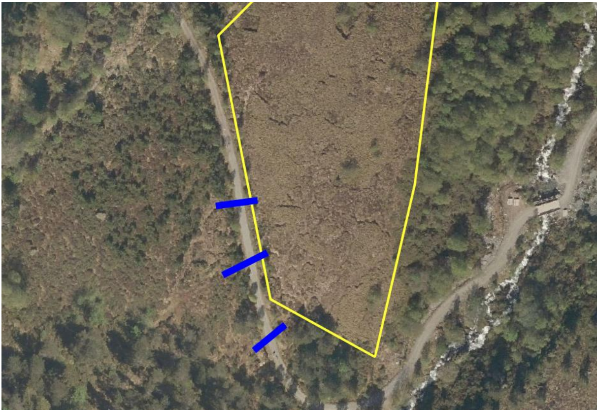
Figur 4. Forslag til plassering av røyr (blå strekar) under Vonløypa for å gjenopprette tilsig til myra ved Gamlestølen.
